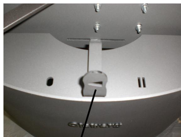
Bedienhebel für die Verbrennungsluftzufluhr
