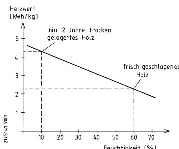
Nur mit trockenen Brennstoffen erreichen Sie eine optimale Verbrennung und heizen umweltschonend. Durch die Brennstoffaufgabe in Teilmengen wird eine unnötige Emission vermieden. Einen sauberen Abbrand erkennen Sie daran, daß sich die Schamotte hell verfärbt.
