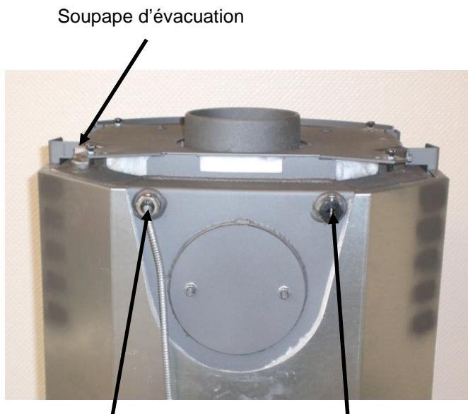
Pour monter la sonde de température dans l'échangeur thermique à eau du poêle à bois, dévisser le panneau arrière. Insérer la sonde dans le manchon d'immersion droit et bloquer avec la vis filetée.
