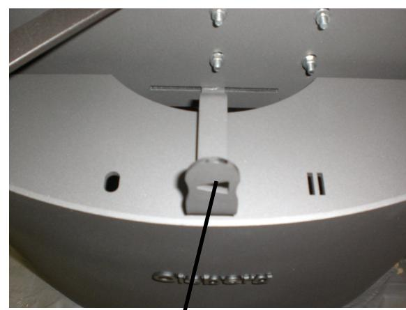
Levier de commande pour l'alimentation en air de combustion
