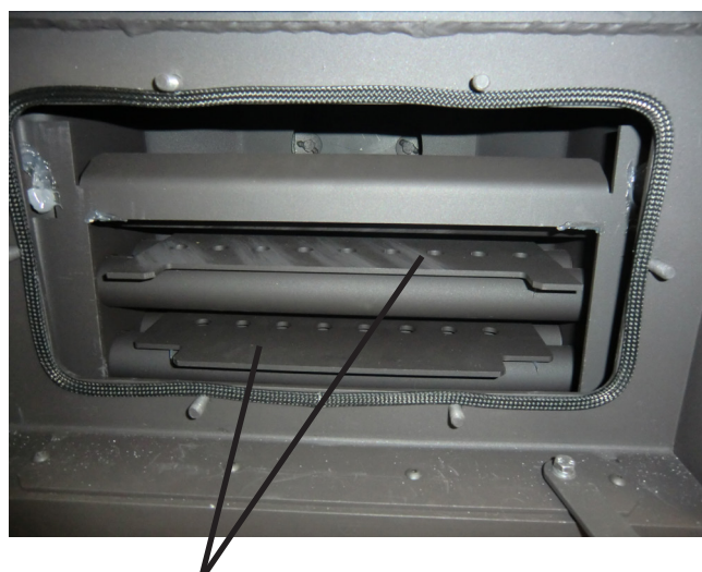
Fig. 6 Tôles de l'échangeur de chaleur
